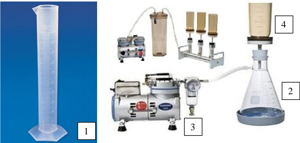
Figura 1 Kit de filtrado para lagos ejemplo 1. Probeta 2. Matraz Kitasato 3. Bomba de vacío 4. Vaso de filtración.
